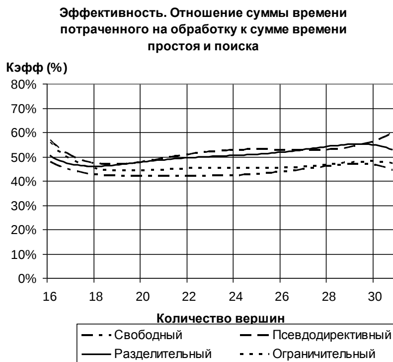
Рисунок 43 – График изменения критерия эффективности для эксперимента с переменным количеством вершин
