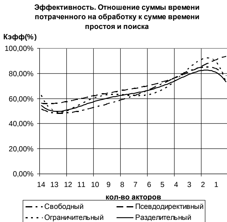
Рисунок 47 – График изменения критерия эффективности для эксперимента с переменным количеством акторов
