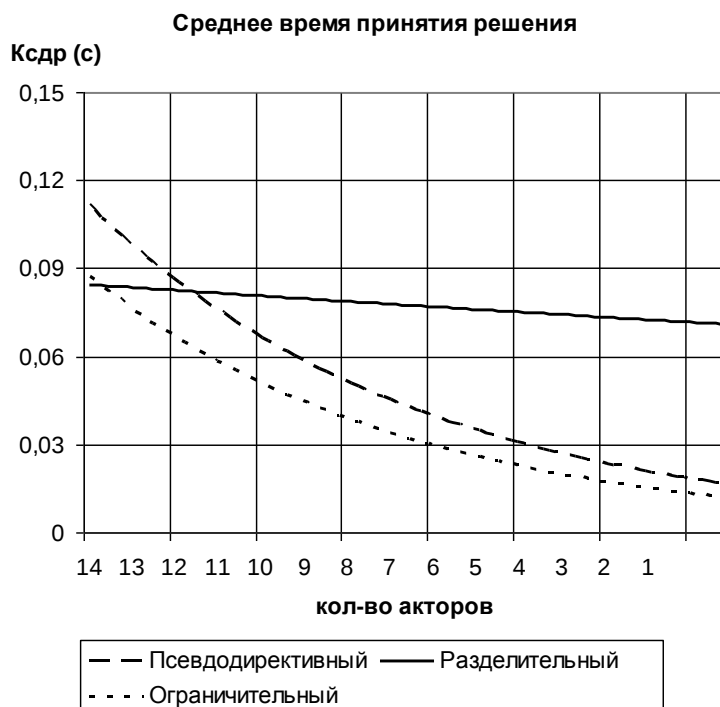
Рисунок 48 – График изменения среднего времени принятия решения для эксперимента с переменным количеством акторов
