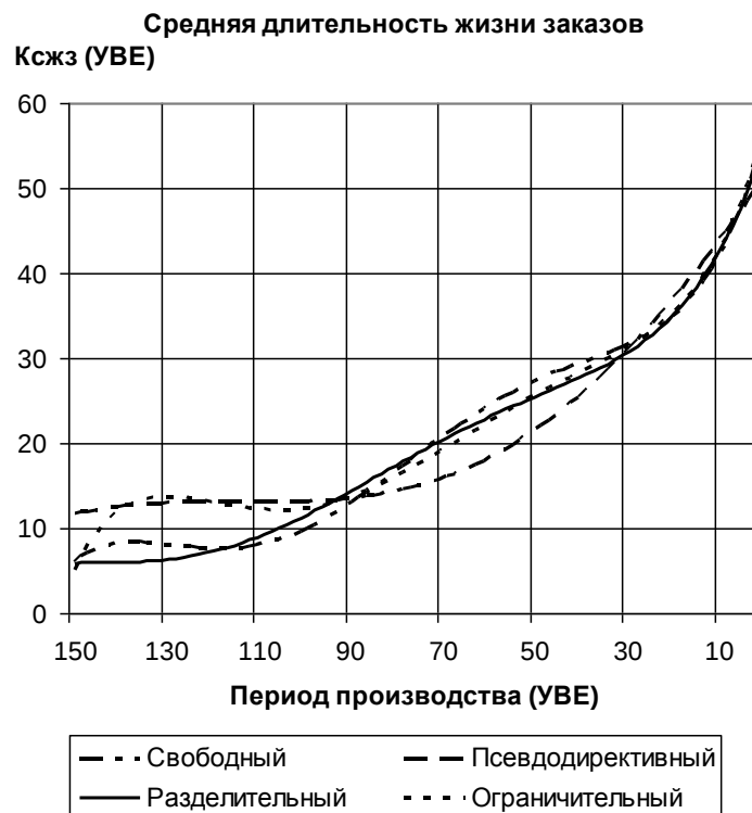
Рисунок 50 – График изменения критерия средней длительности жизни заказов для эксперимента с переменной производительностью вершин
