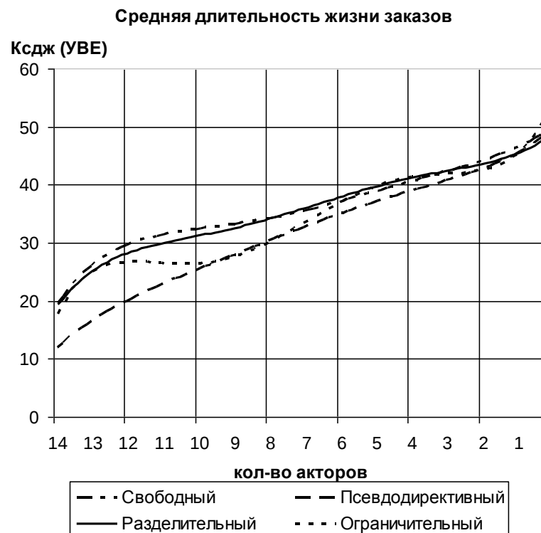
Рисунок 46 – График изменения критерия средней длительности жизни заказов для эксперимента с переменным количеством акторов
