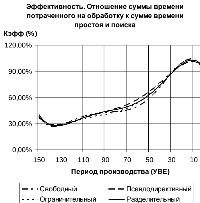
Рисунок 51 – График изменения критерия эффективности для эксперимента с переменной производительностью вершин
